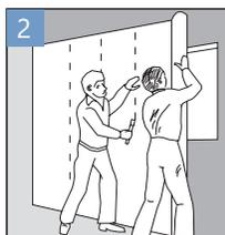
2 Cubrir ventanas y puertas con Tyvek® mientras se envuelve la pared de la casa, e ir grapando a la vez, solapando 150 mm cuando se empalmen 2 rollos. Una persona va desenrollando, la otra va grapando.
